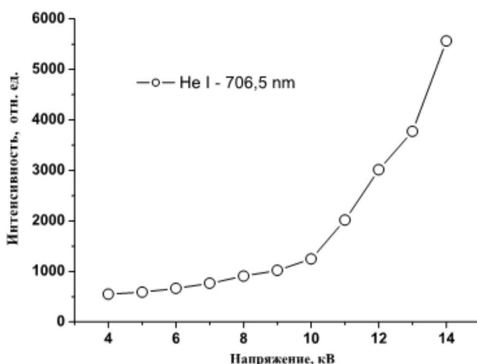
Рисунок 3.28 – Интенсивность спектральных линий *He I* при разных напряжениях разряда
