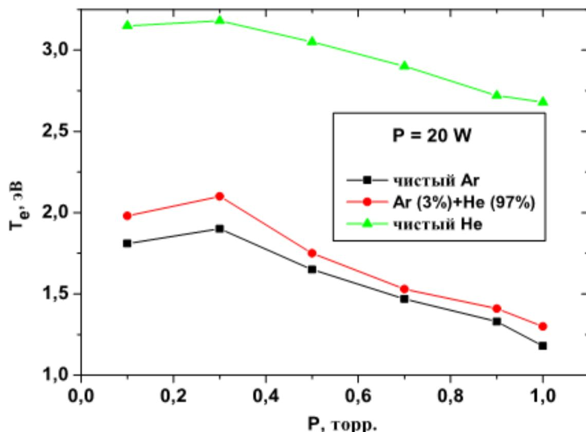
Рисунок 2.12 – Зависимость температуры электронов от давления газовой смеси
