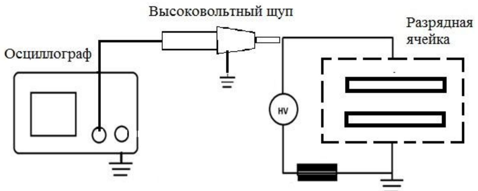
Рисунок 3.6 – Схема подключения высоковольтного щупа для измерения электрических характеристик ДБР
