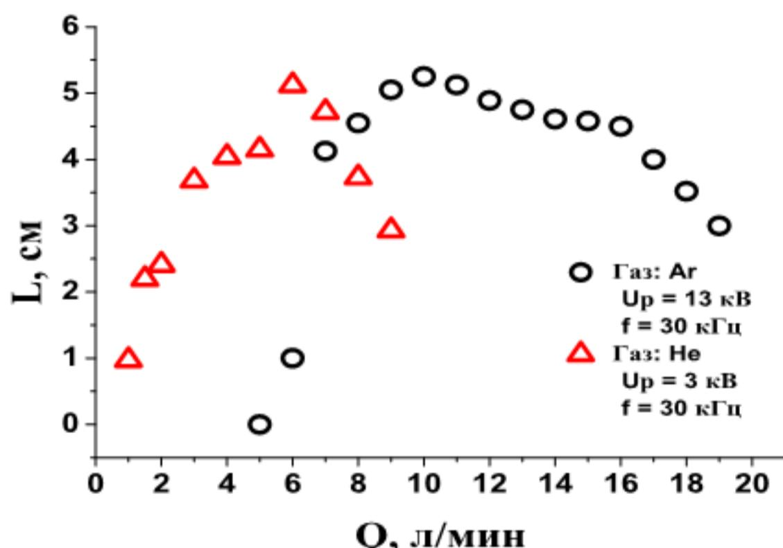
Рисунок 3.32 – Зависимость длины плазменной струи от расхода газа, рабочий газ  $Ar$
