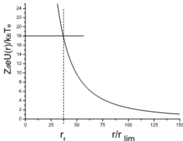
Рисунок 2.6 – Энергия взаимодействия пылевых частиц с электрическим зондом (кривая линия), тепловая энергия пылевых частиц (сплошная прямая линия), экспериментально определенный радиус свободной зоны (пунктирная линия): по оси ординат обозначены энергии взаимодействия, по оси абсцисс – расстояние от зонда.
