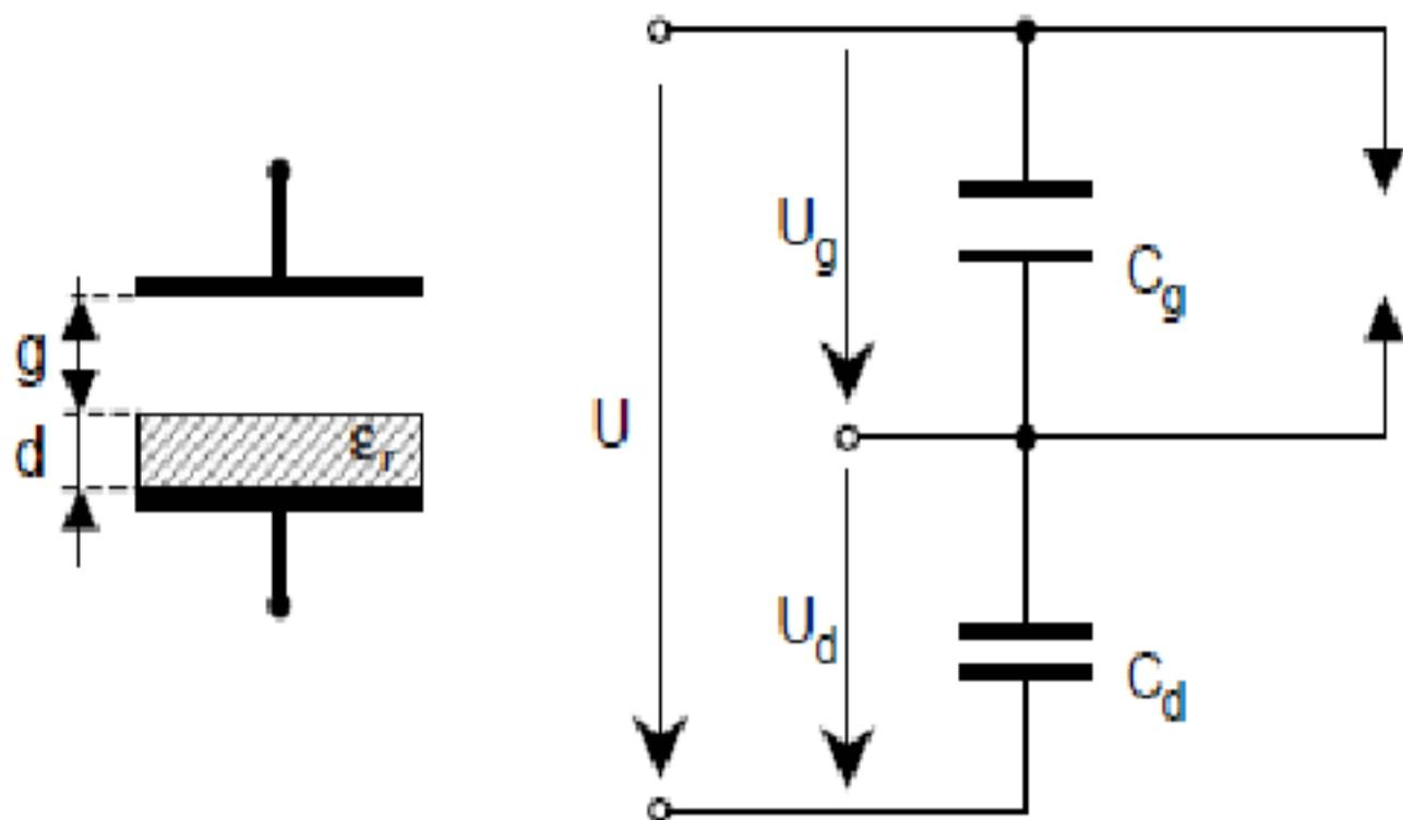
Рисунок 3.7 – ДБР с одним барьерным электродом и эквивалентная схема разряда
