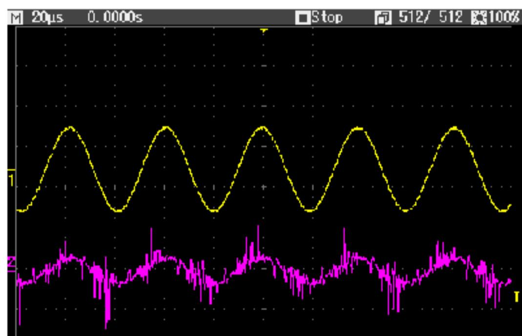
Рисунок 3.22 – Динамическая ВАХ разряда, рабочий газ *Ar*
