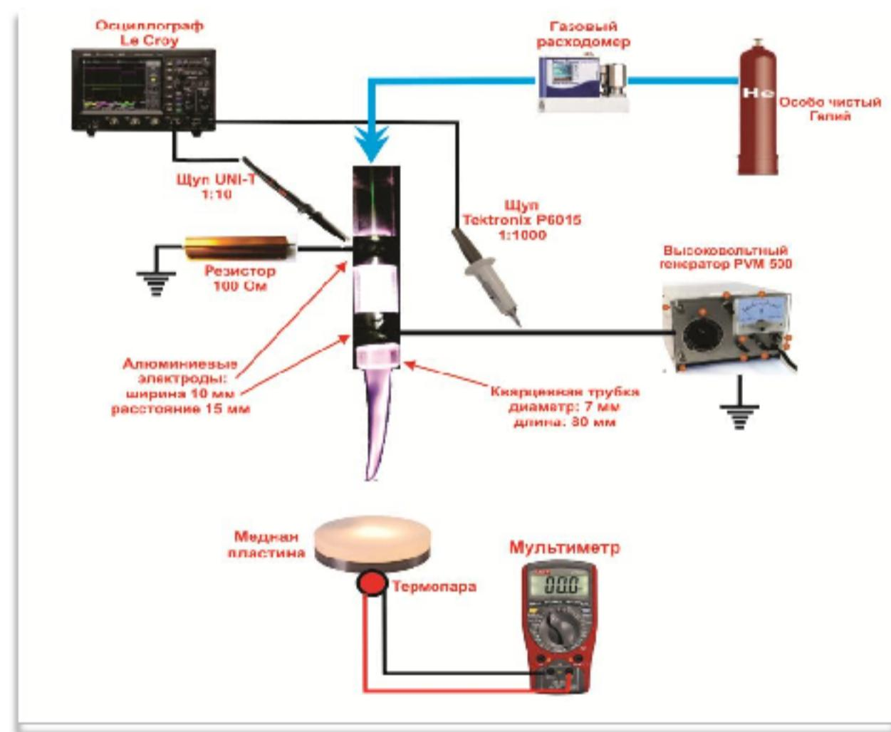
Рисунок 3.19 – Общая схема экспериментальной установки на основе источника плазменной струи атмосферного давления (ПСАД)
