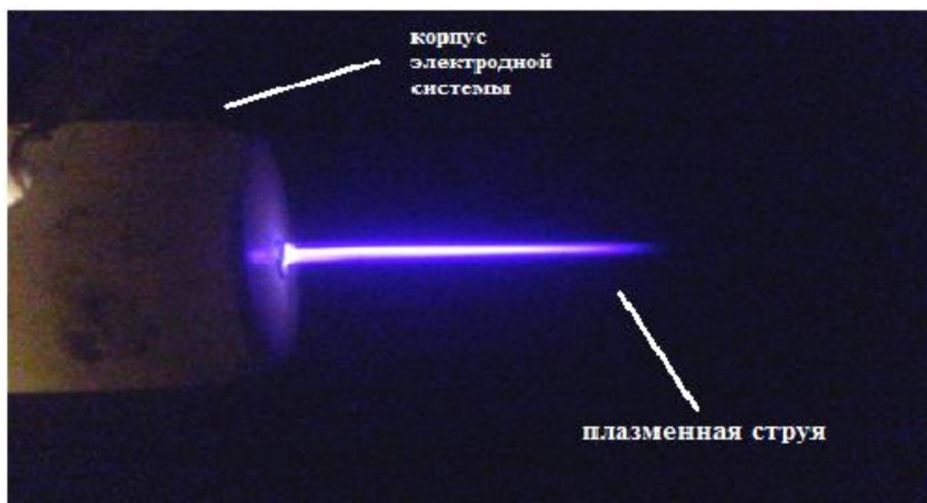
Рисунок 3.17 – ПСАД в рабочем режиме при конфигурации с высоковольтным электродом в форме иглы. Рабочий газ - гелий с расходом 6 л/мин, напряжение 3 кВ, частота 30 кГц
