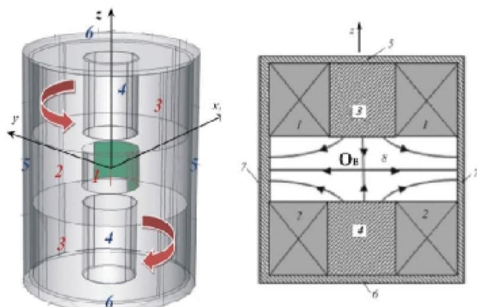
1 - ампула с электродами и диамагнитными частицами, 2 - сменный контейнер, 3 - электромагниты, 4 - полость между магнитами, 5,6 - кожух
