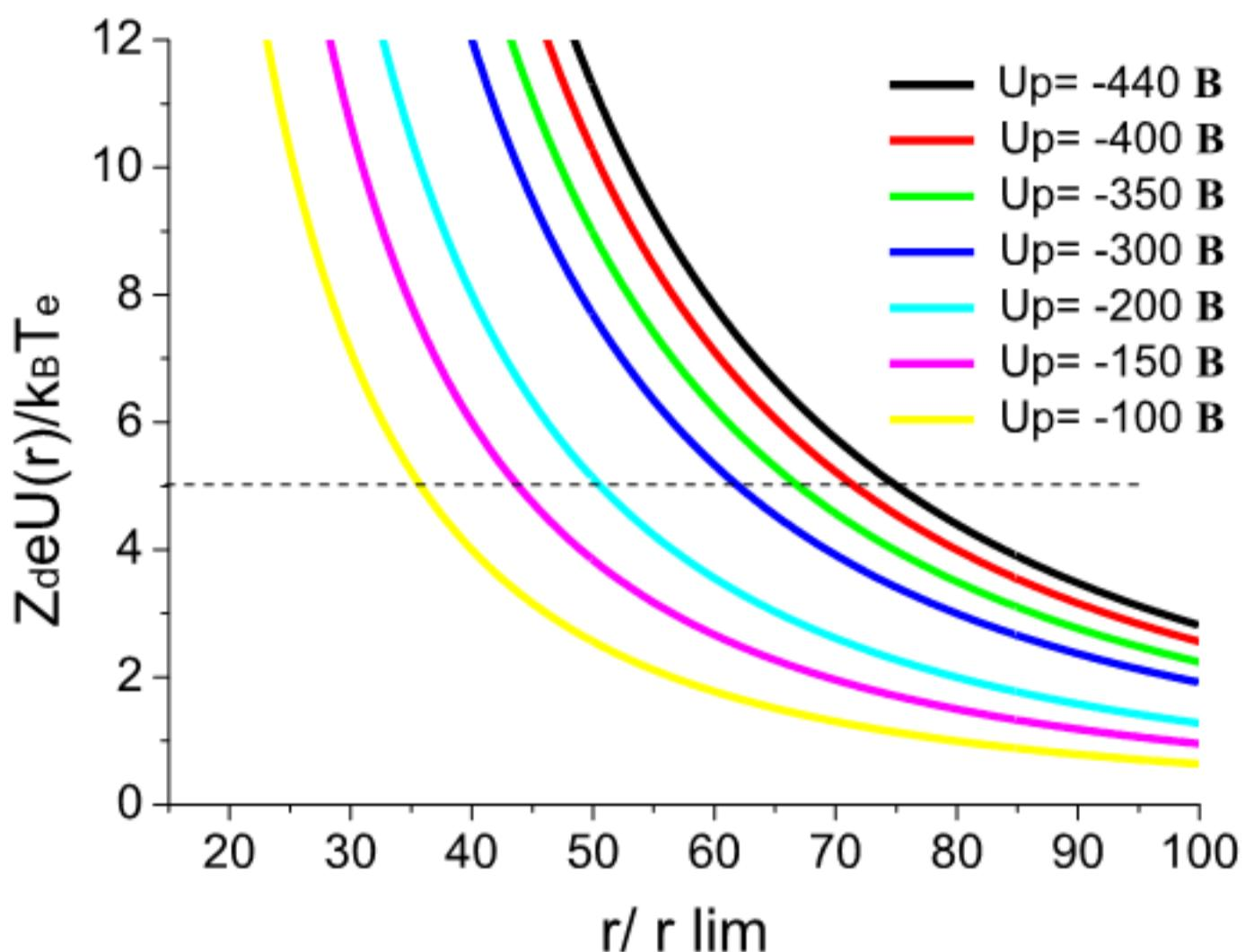
Рисунок 2.4 – Зависимость энергии взаимодействия пылевых частиц и электрического зонда от расстояния. Пунктирная линия соответствует тепловой энергии пылевых частиц
