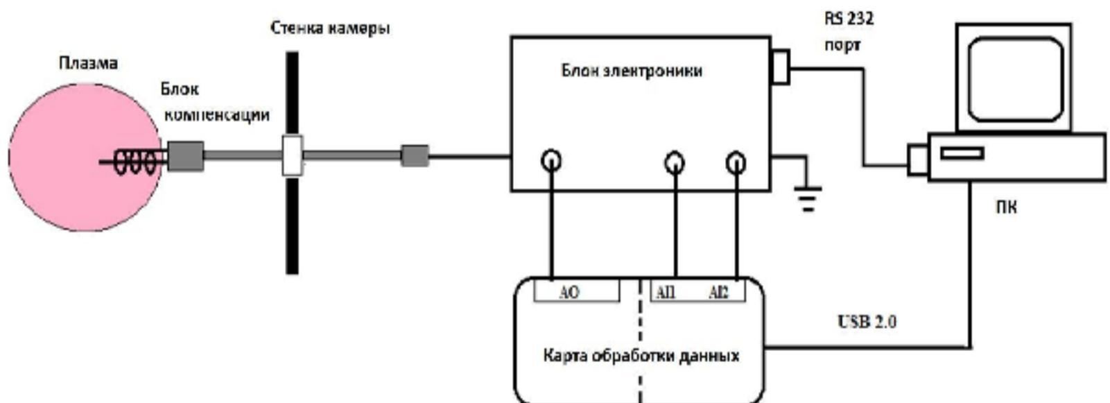
Рисунок 2.17 – Схема соединения ленгмюровского зонда
