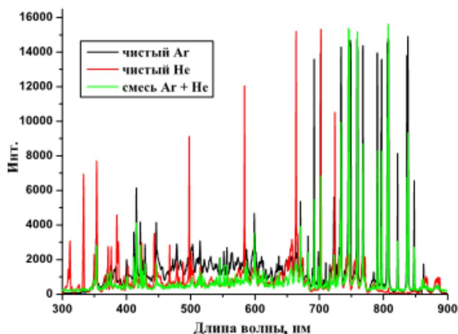
Рисунок. 2.10 – Спектр буферной плазмы аргон, гелий в области 450 - 900 нм
