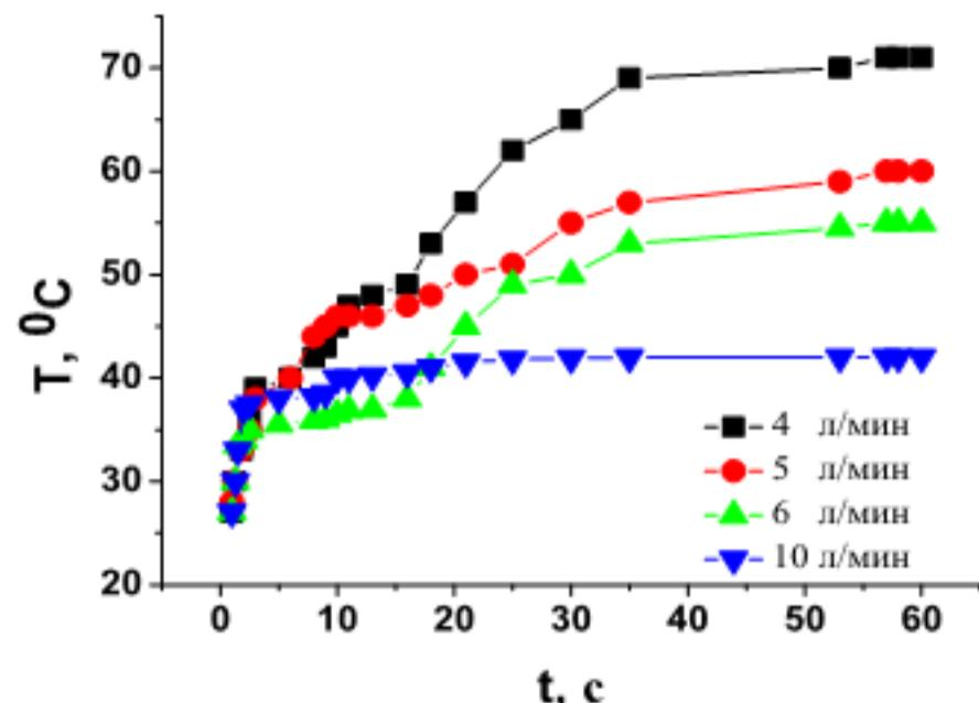
Рисунок 3.35.- Зависимость температуры калориметра в конце плазменной струи от расхода газа Не
