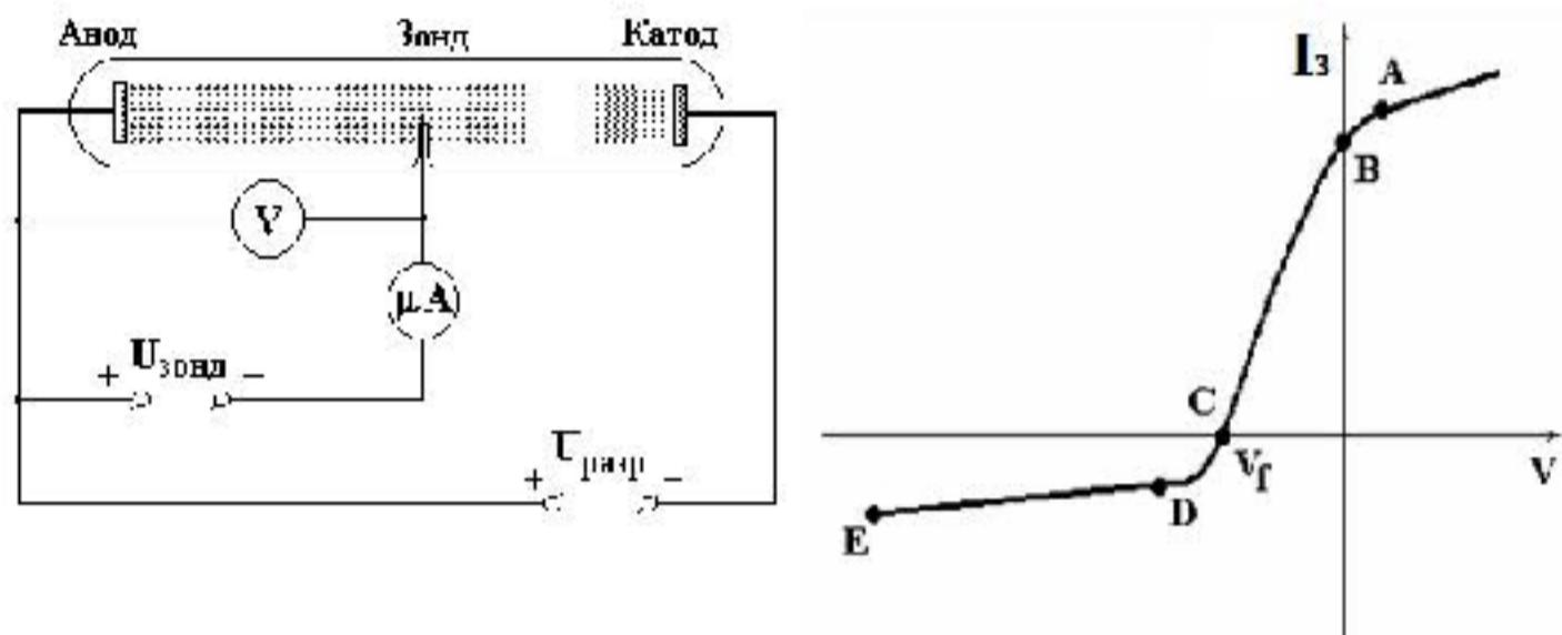
Рисунок 1.1 – Схема измерения электрического зонда и ее вольт-амперная характеристика
