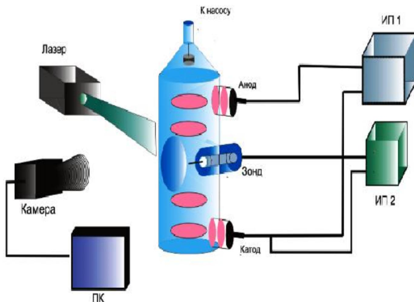
Рисунок 2.1 – Схема экспериментальной установки тлеющего разряда
