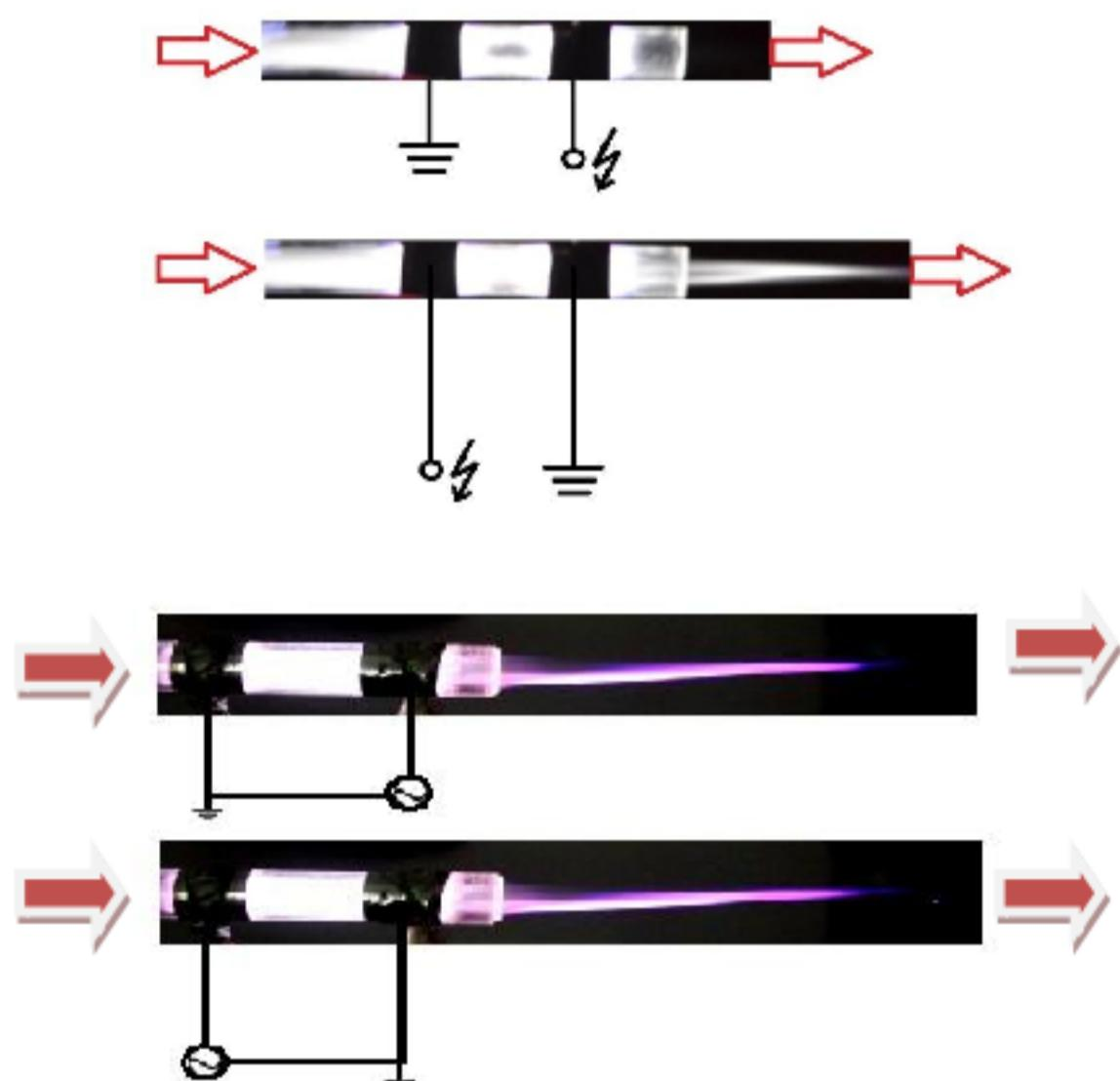
Верхний рисунок - плазменная струя аргона, нижний рисунок - плазменная струя гелия
