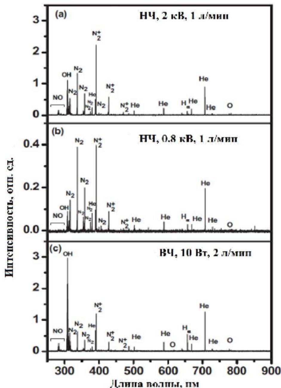
Рисунок 1.9 – Спектры излучения от 200 до 900 нм наблюдаемые в плазменной струе гелия
