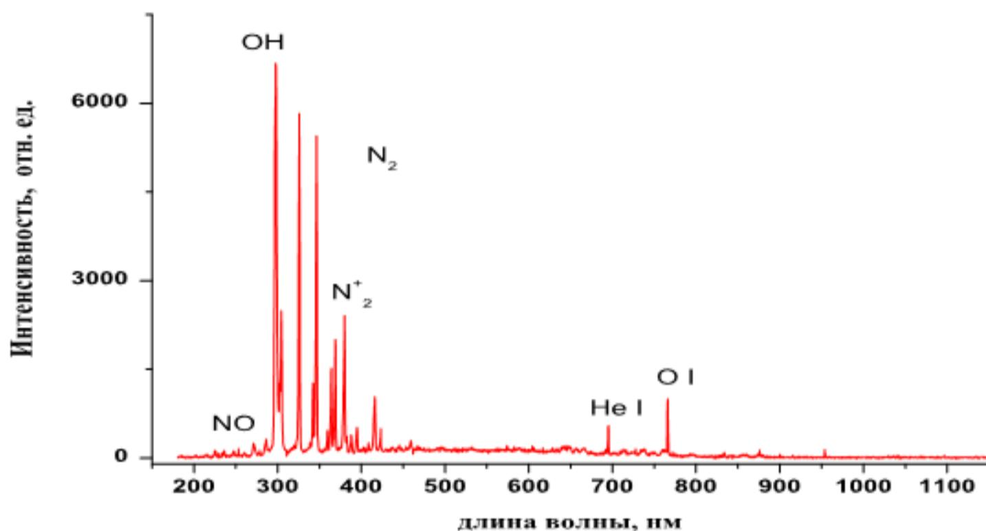
Рабочий газ: гелий, напряжение на разрядных электродах: 4 кВ, частота: 30 кГц, расход газа: 6 л/мин
