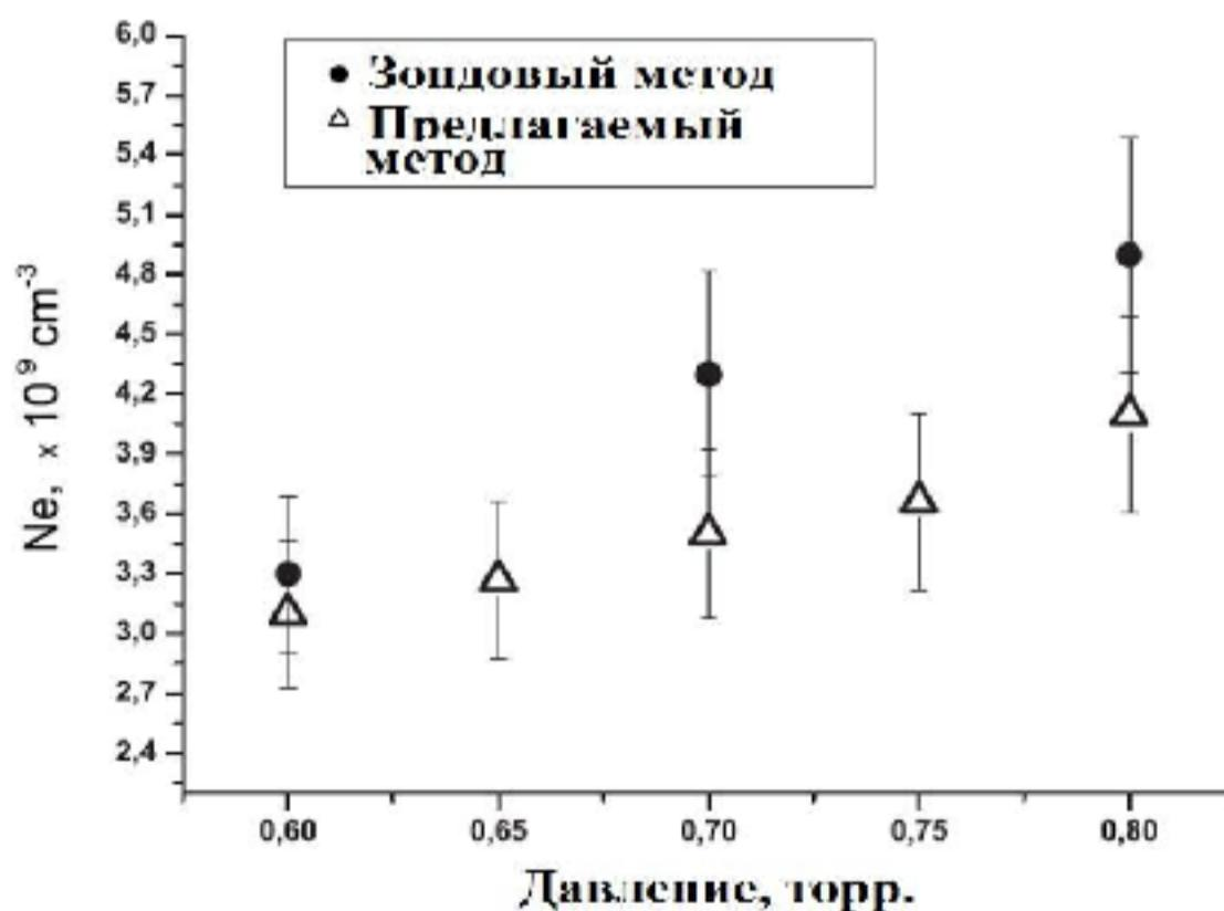
Рисунок 2.8 – Зависимость концентрация электронов, определенная с помощью измерения радиуса области свободной от пылевых частиц вокруг электрического зонда от давления и ее сравнение с классическим зондовым методом.
