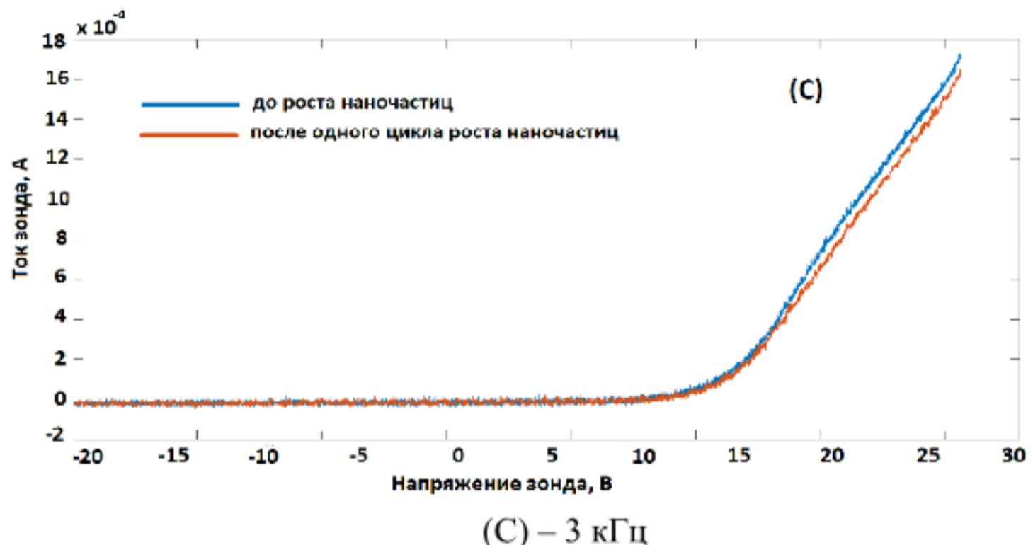
Рисунок 2.21, лист 2 – ВАХ зонда до и после одного цикла роста наночастиц при разных частотах  $f_{probe}$
