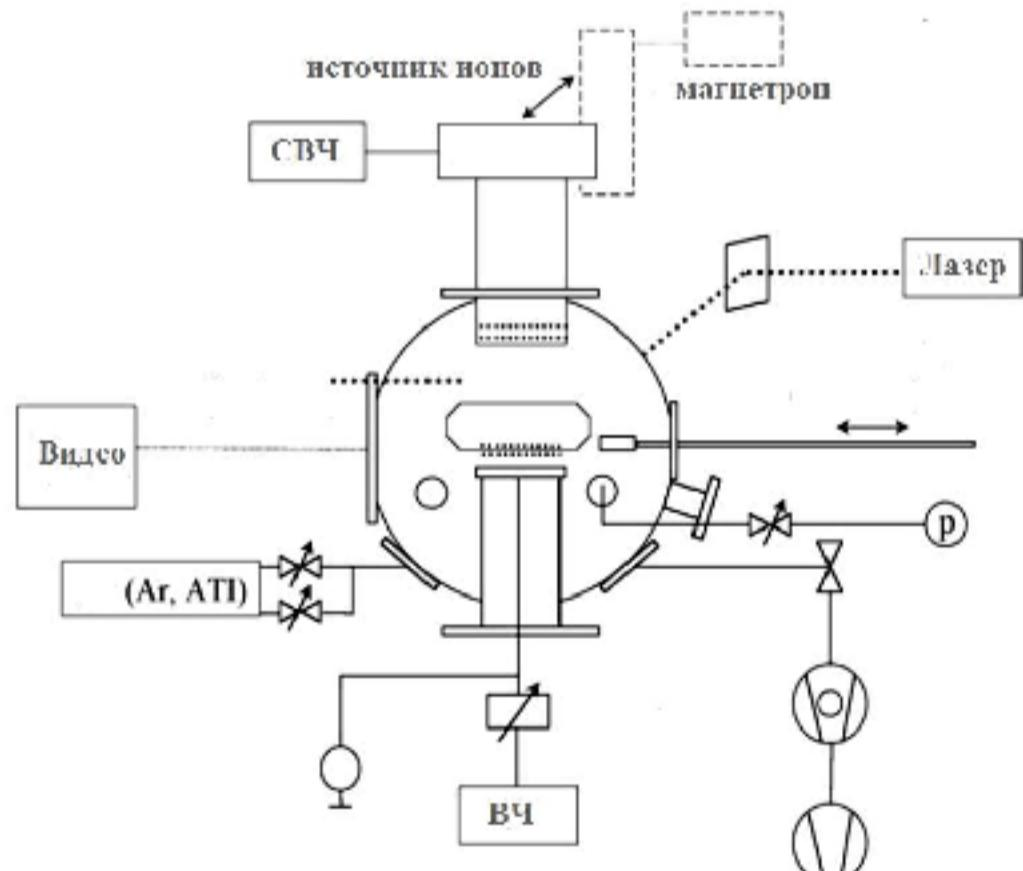
Рисунок 1.4 – Схема экспериментальной установки для определения параметров плазмы используя пылевые микрочастицы в качестве зонда [46]
