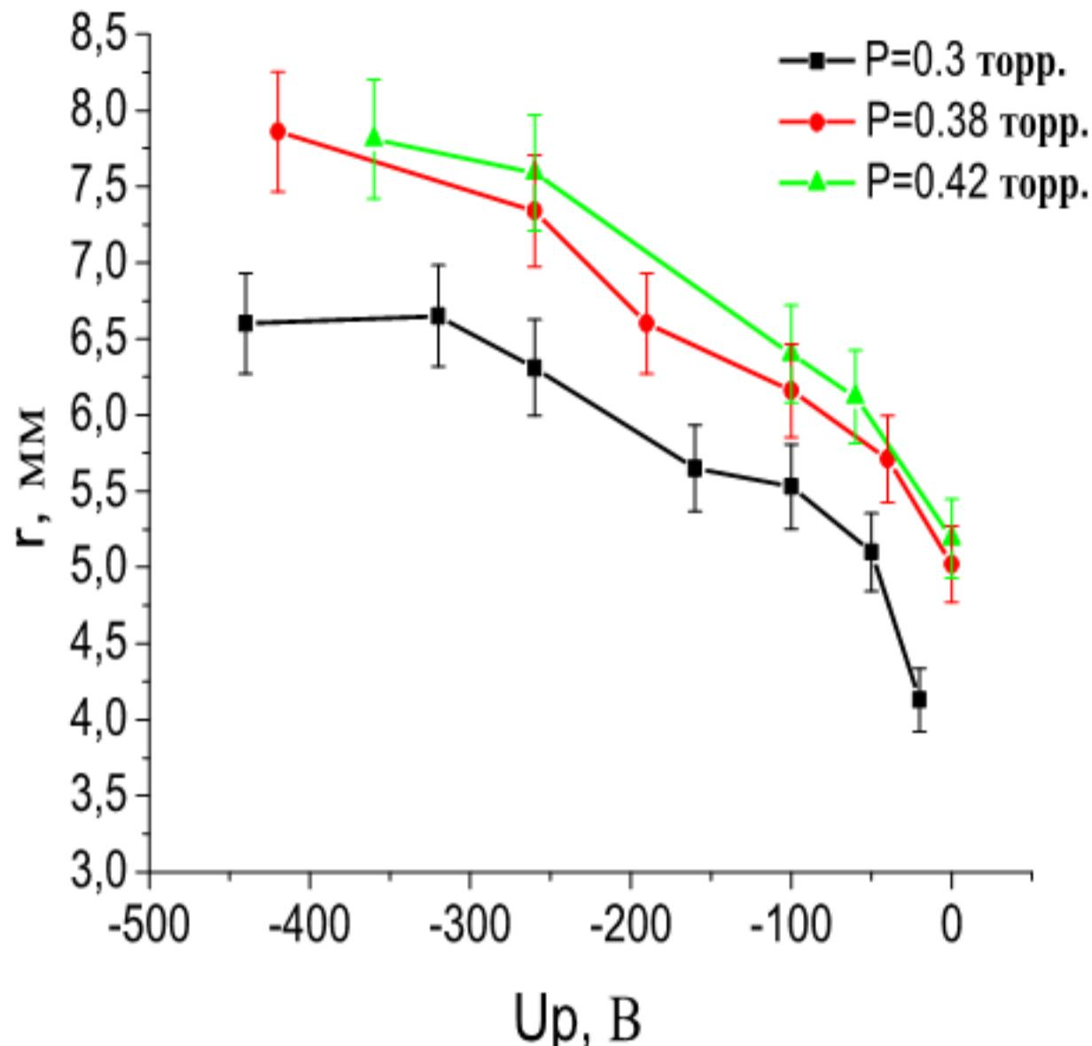
Рисунок 2.3 – Зависимость радиуса области свободной от пылевых частиц от потенциала зонда при разных давлениях разряда
