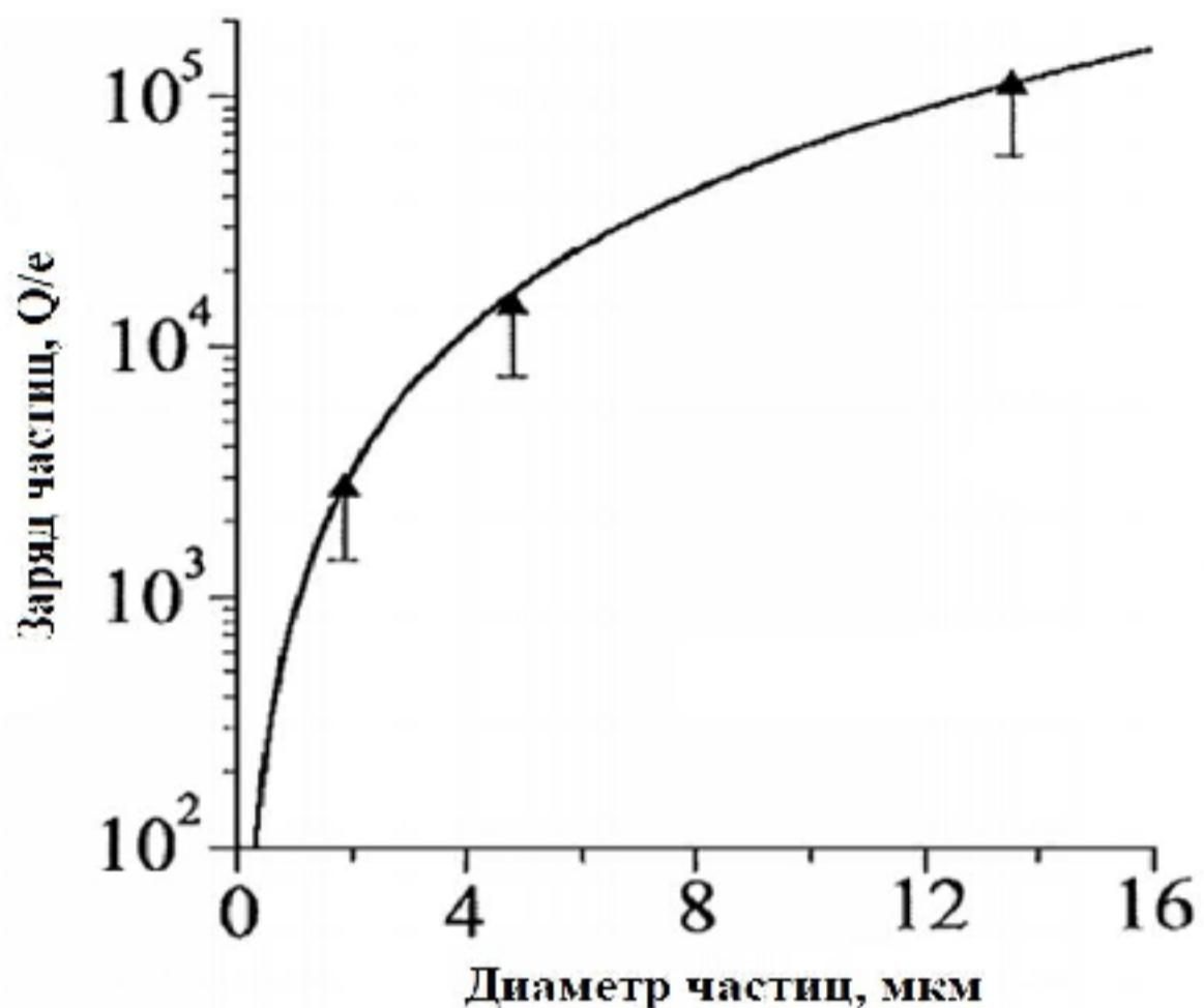
Рисунок 1.7 – Зависимость заряда пылевой частицы от ее размеров определенная методом воздействия лазерного пучка [47]
