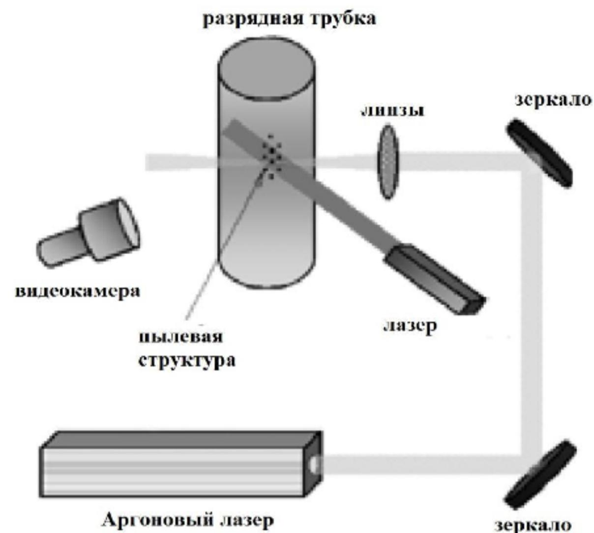
Рисунок 1.6 – Схема экспериментальной установки для определения заряда пылевых частиц в стратах тлеющего разряда
