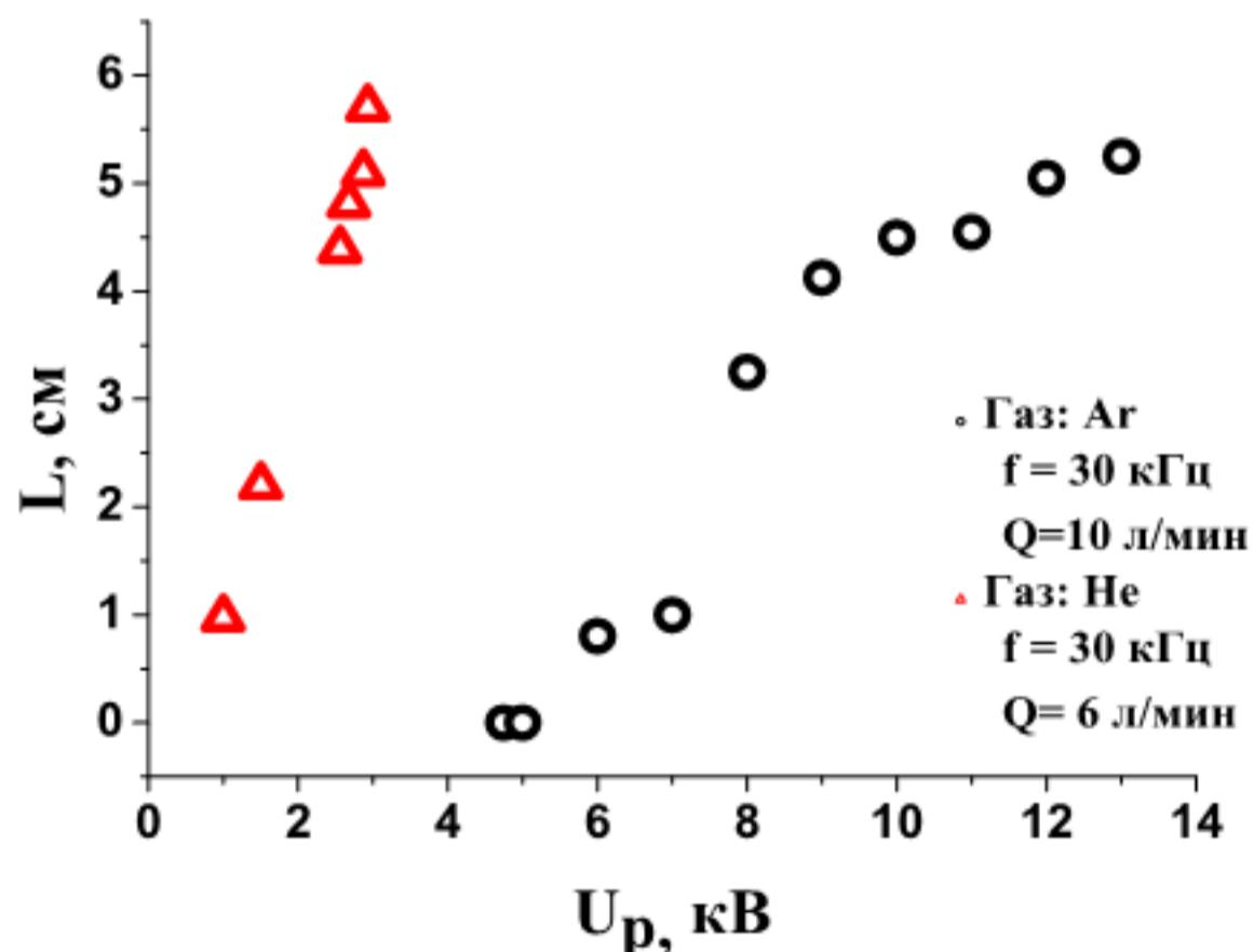
Рисунок 3.33 – Зависимость длины плазменной струи от напряжения разряда для разных рабочих газов
