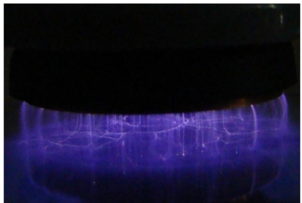
Рисунок 3.2 – Медные электроды применяемые для конфигурации «плоскость–плоскость» и плазма диэлектрического барьера разряда при данной конфигурации
