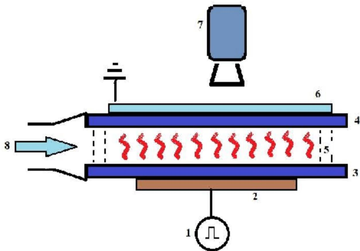
1- высоковольтный генератор, 2 – высоковольтный металлический электрод, 3, 4 – стекляные пластины, 5 – боковые стенки из стекла, 6 – прозрачный проводящий электрод, 7 – ПЗС камера, 8- поток газа
