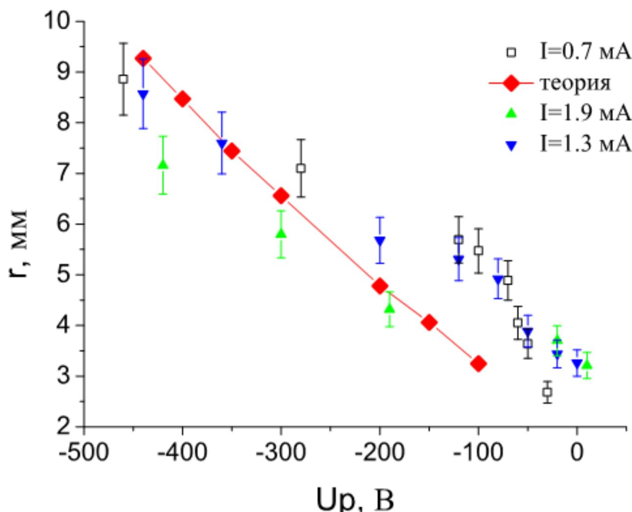
Рисунок 2.5 – Зависимость расстояния между зондом и пылевыми частицами от потенциала зонда. Сравнение экспериментальных данных с результатами моделирования при разных значениях тока разряда при давлении в разрядной трубке  $P=0.3$  торр.
