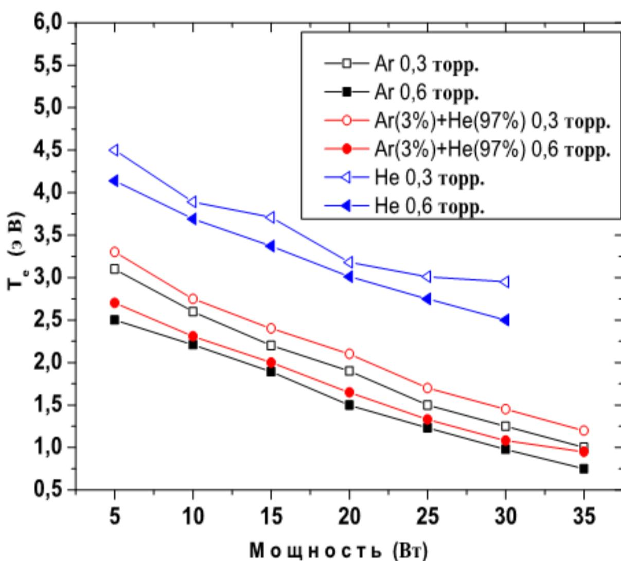
Рисунок 2.11 – Зависимость электронной температуры от ВЧ напряжения в различных газах и их смесях
