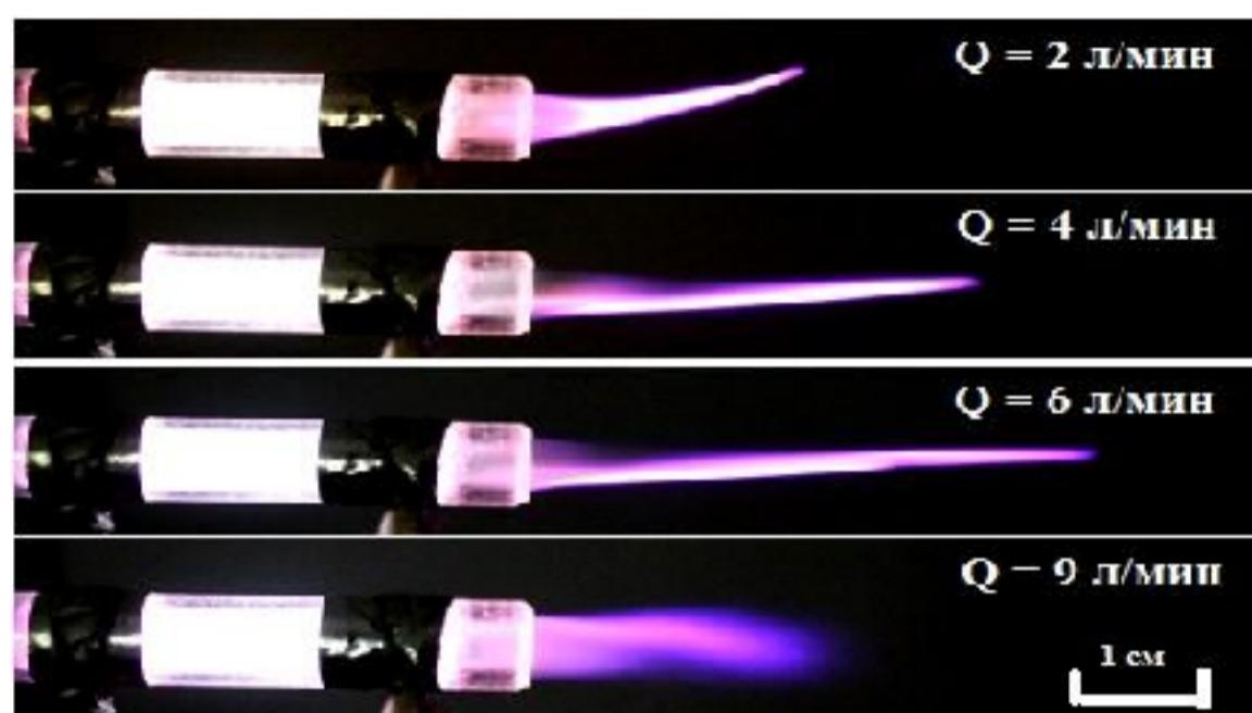
Рисунок 3.31 – Микроплазмотрон в рабочем режиме при разных расходах газа, рабочий газ гелий
