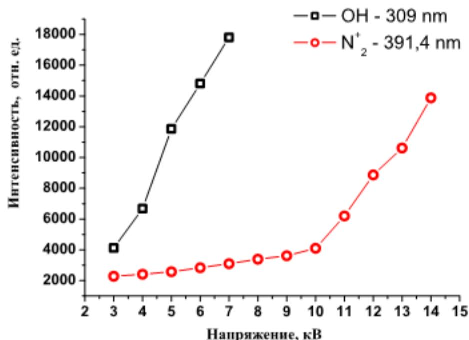
Рисунок 3.27 – Интенсивности спектральных линий OH и  $N_2^+$  при разных напряжениях разряда, рабочий газ: гелий
