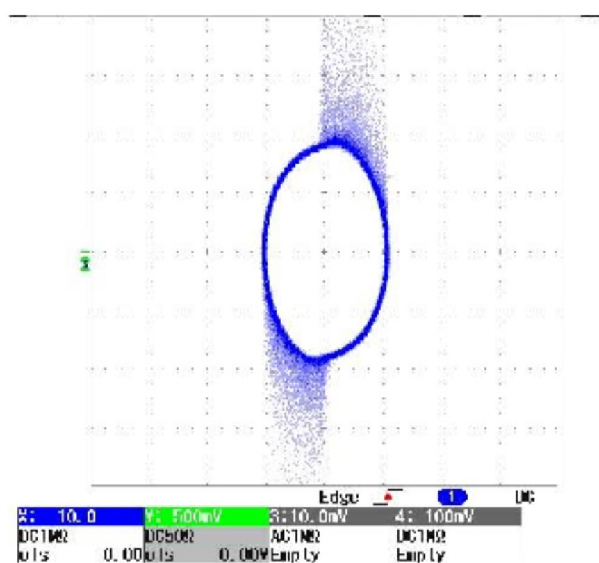
Рисунок 3.10 – Типичная вольт-кулоновская характеристика ДБР при геометрии электродов «плоскость-плоскость»
