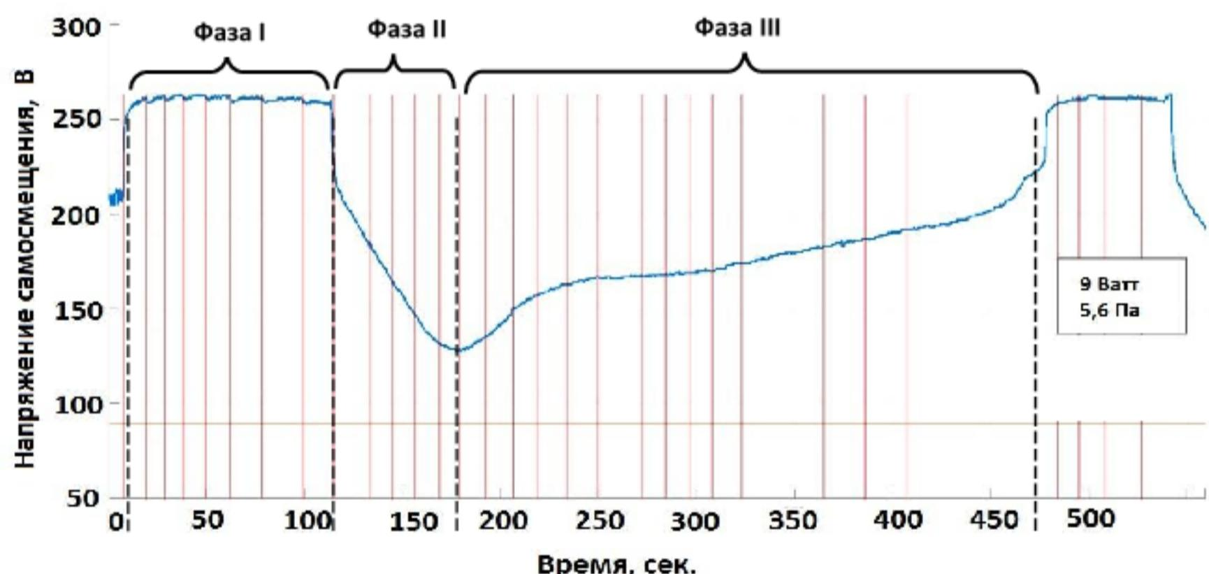
Расход аргона  $Q_{Ar} = 7,7 \text{ см}^3/\text{мин}$ , ацетилена  $Q_{C_2H_2} = 0,5 \text{ см}^3/\text{мин}$ , давление  $P = 5,6 \text{ Па}$ , мощность  $9 \text{ Вт}$ . Красные вертикальные прямые линии соответствуют началу снятия одной ВАХ зондом.
