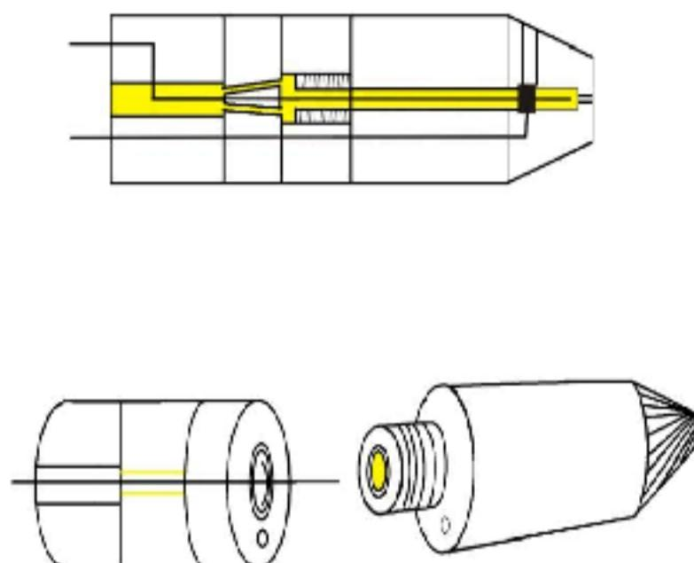
Рисунок 3.16 – Конструкция электродов ПСАД: высоковольтный электрод имеет форму иглы и расположен вдоль оси канала распространения разряда
