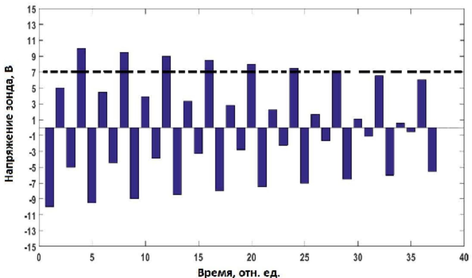
Рисунок 2.18 – Зависимость от времени (относительные единицы) приложенного напряжения на зонд при «комплексной» развертке зондового напряжения. Пунктирной линией обозначен условный потенциал плазмы.
