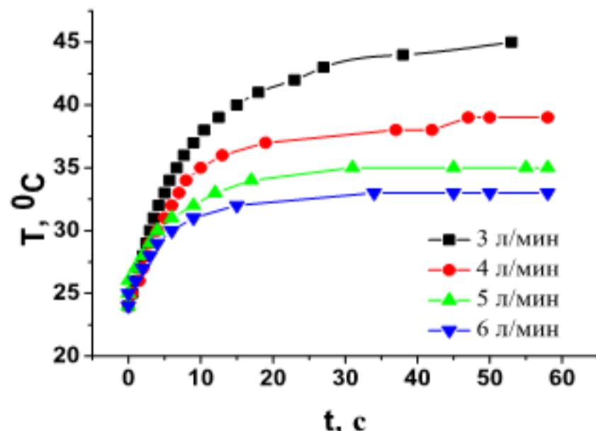
Рисунок 3.34- Зависимость температуры калориметра в конце плазменной струи от расхода газа Ar
