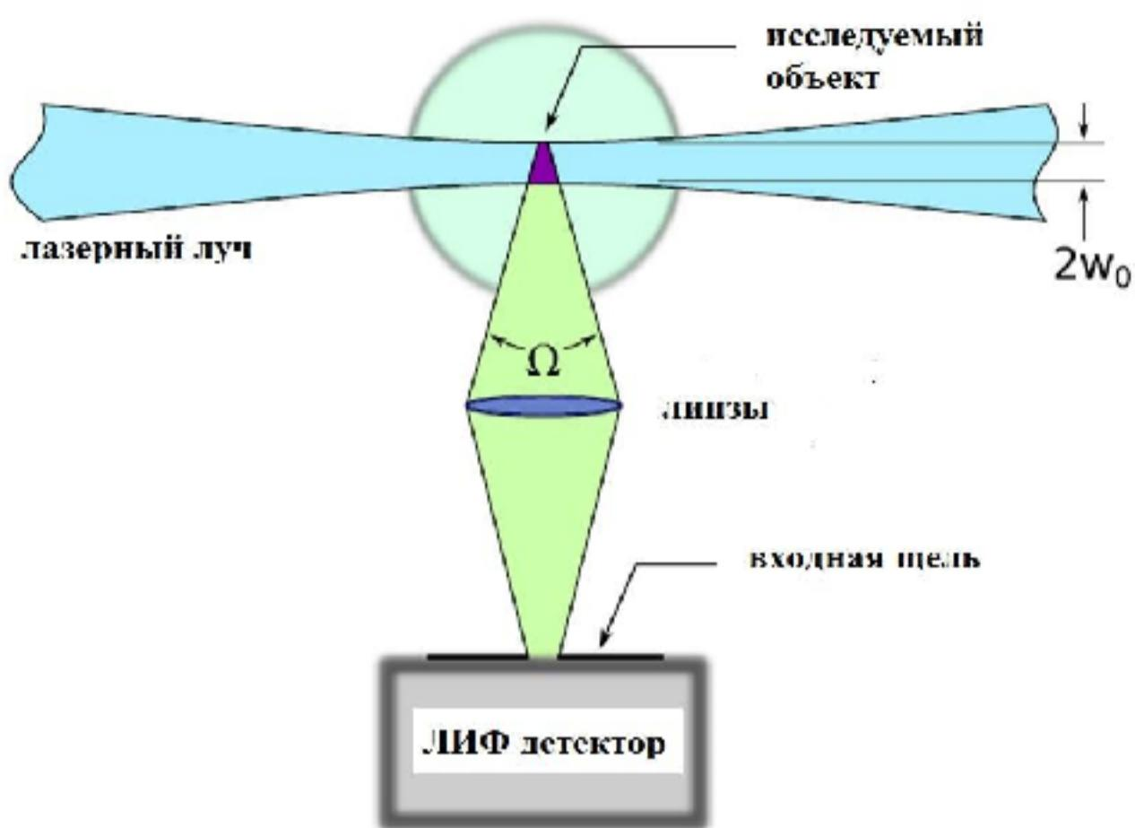
Рисунок 1.10 – Типичная схема эксперимента по диагностике плазмы методом ЛИФ
