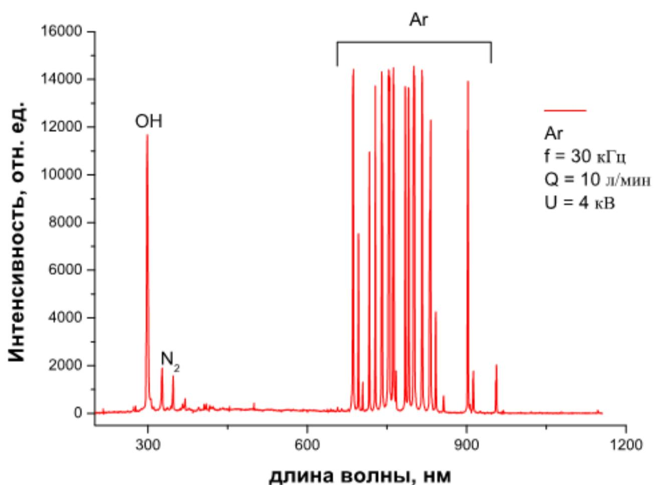
Рабочий газ: аргон, напряжение на разрядных электродах: 4 кВ, частота: 30 кГц, расход газа: 10 л/мин.
