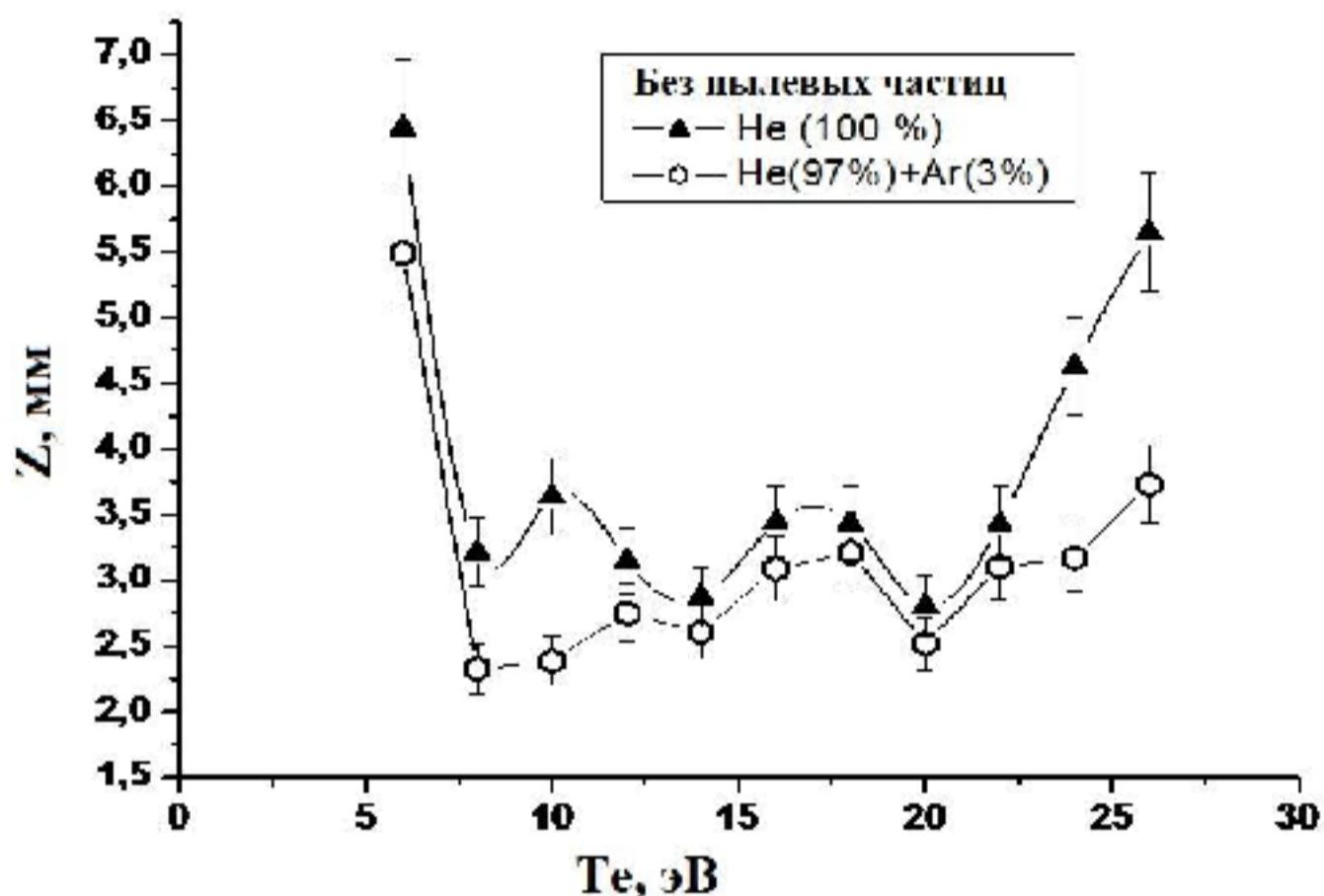
Рисунок 2.13 - Аксиальное распределение температуры электронов плазмы в межэлектродном пространстве в чистом Не и в смеси Не+Аргон. Давление в разрядной камере 0,3 торр, мощность 20 Вт.
