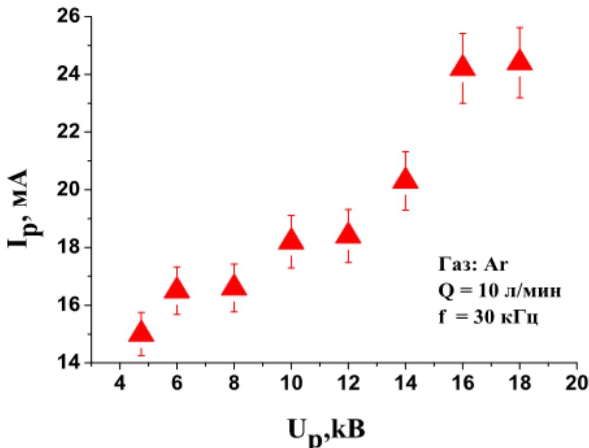
Рисунок 3.24 – Статическая ВАХ разряда, рабочий газ: аргон
