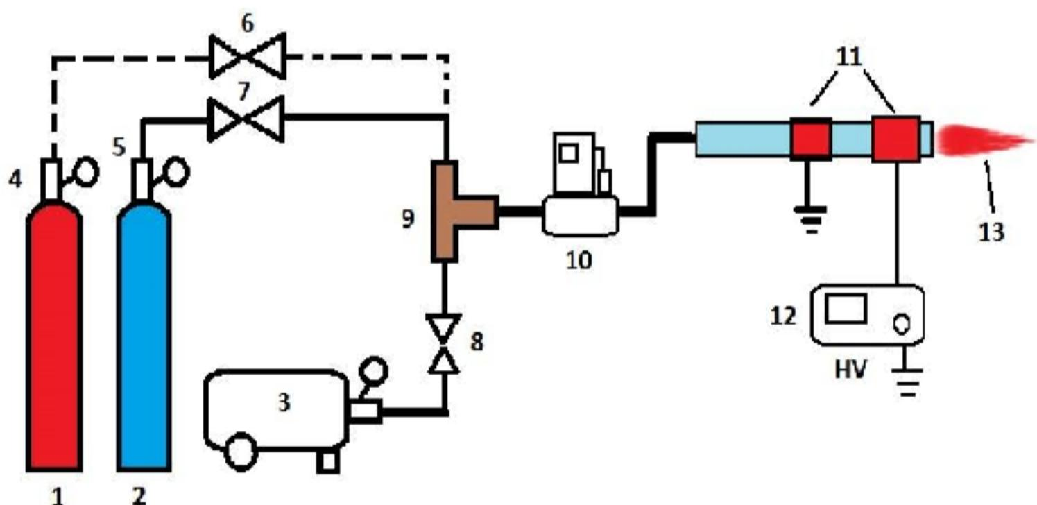
1, 2 -баллоны с инертными газами (гелий и аргон), 3 –компрессор для подачи воздуха, 4,5 – редукторы с измерителями объемного расхода газа, 6,7,8 – механические клапаны для регулировки расхода газов, 9 – тройник-смеситель, 10 – газовый расходомер (модель Bronkhorst M+WSeries), 11 – электроды разряда, 12 – высоковольтный генератор синусоидального напряжения, 13 – низкотемпературная плазма струйного типа при атмосферном давлении
