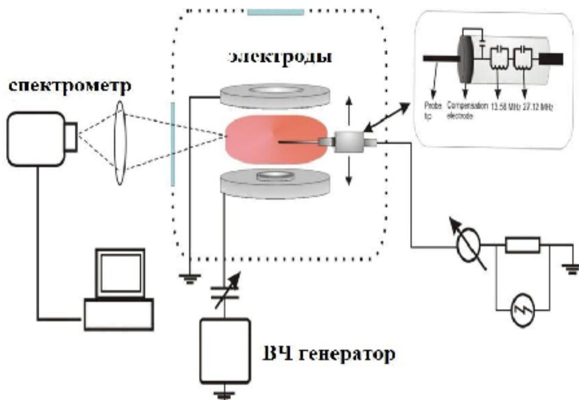
Рисунок 2.9 – Схема экспериментальной установки и схема измерения ВЧ компенсационного электрического зонда.
