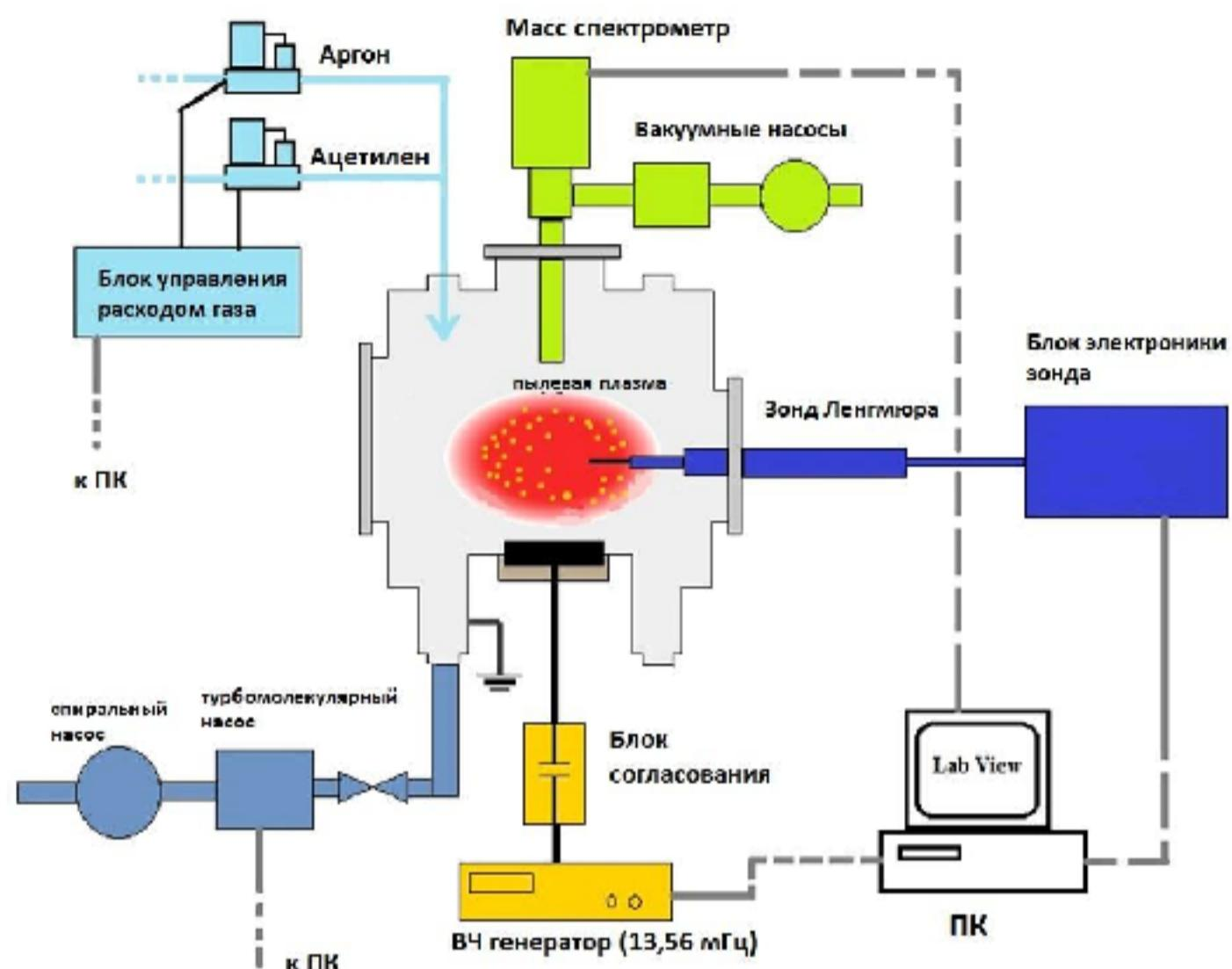
Рисунок 2.16 – Общая схема экспериментальной установки ATILA
