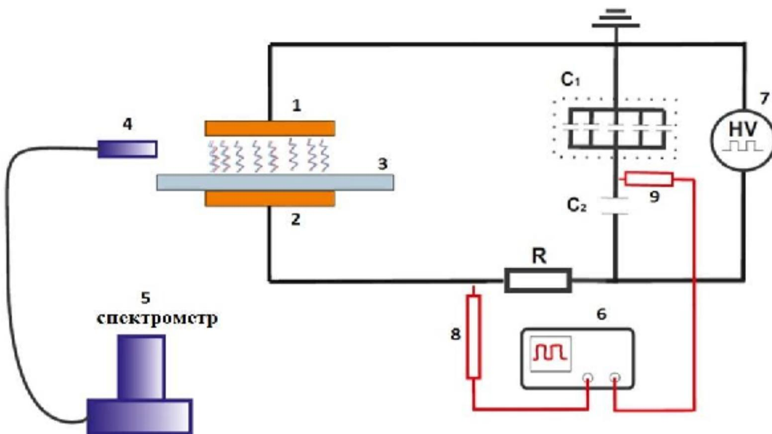
Рисунок 3.4 – Блок измерений электрических и оптических характеристик экспериментальной установки на основе ДБР
