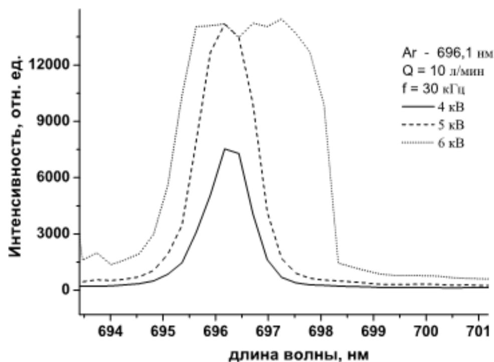
Рисунок 3.30 – Распределение интенсивности спектральных линий отома аргона при длине волны 696,1 нм при разных напряжениях разряда
