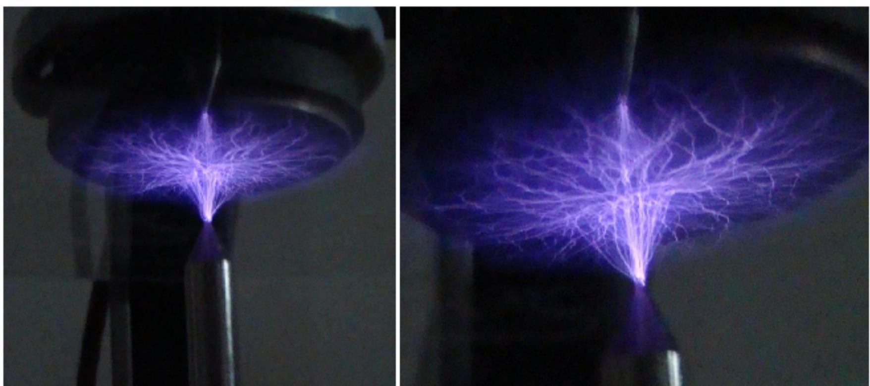
Рисунок 3.3 – Конфигурация электродов «острие-плоскость» и плазма диэлектрического барьера разряда при данной конфигурации
