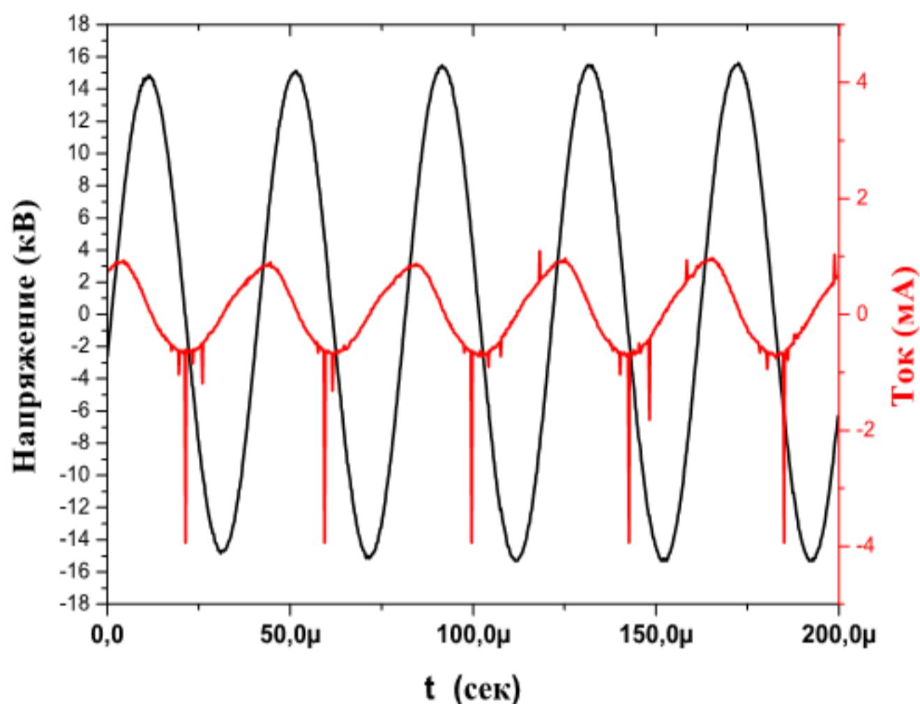
Рисунок 3.9 – Динамическая вольт-амперная характеристика диэлектрического барьерного разряда: геометрия электродов «плоскость-острие»
