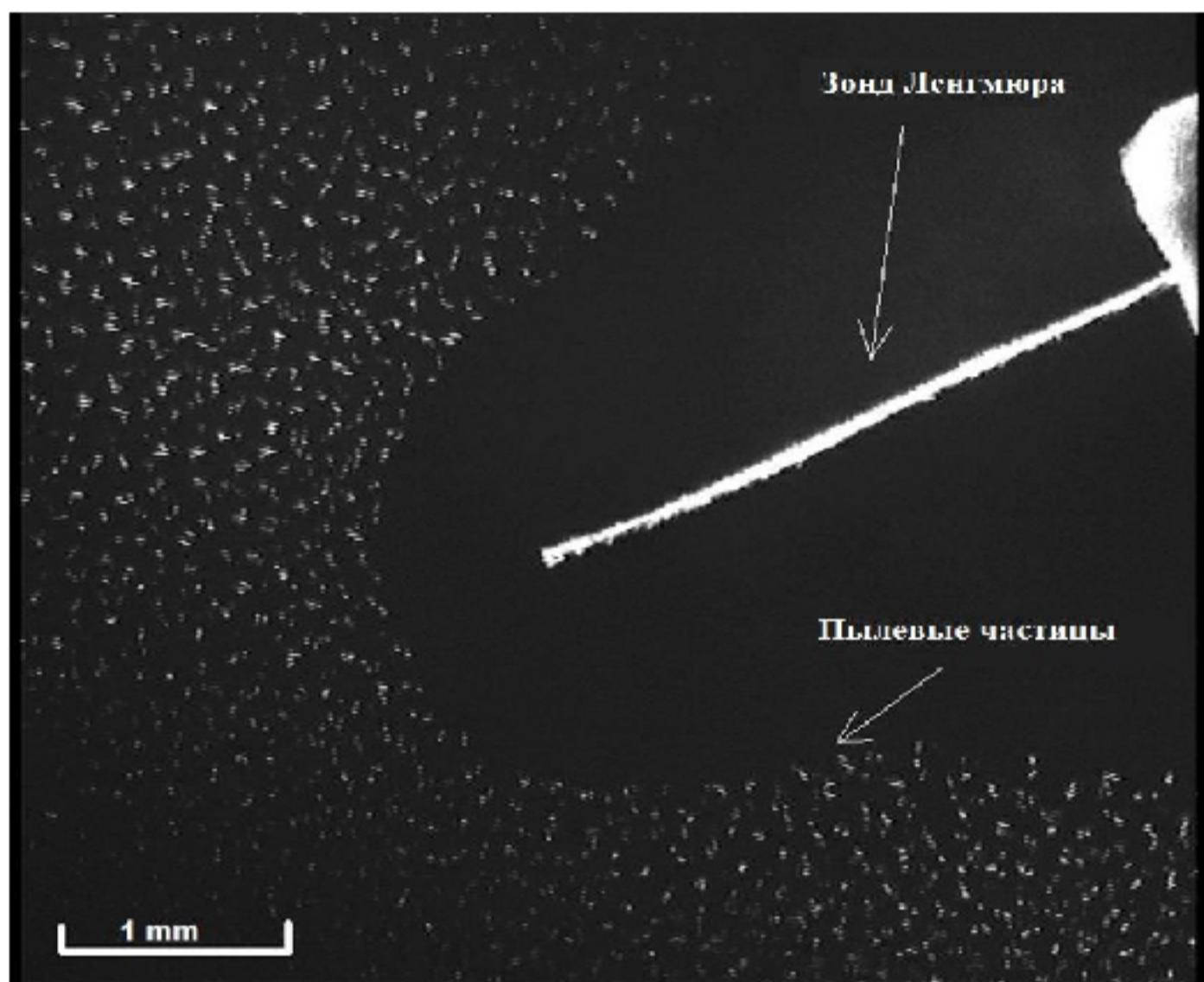
Рисунок 2.14 – Фотоизображение собирающей части ленгмюровского зонда при взаимодействии с пылевыми частицами
