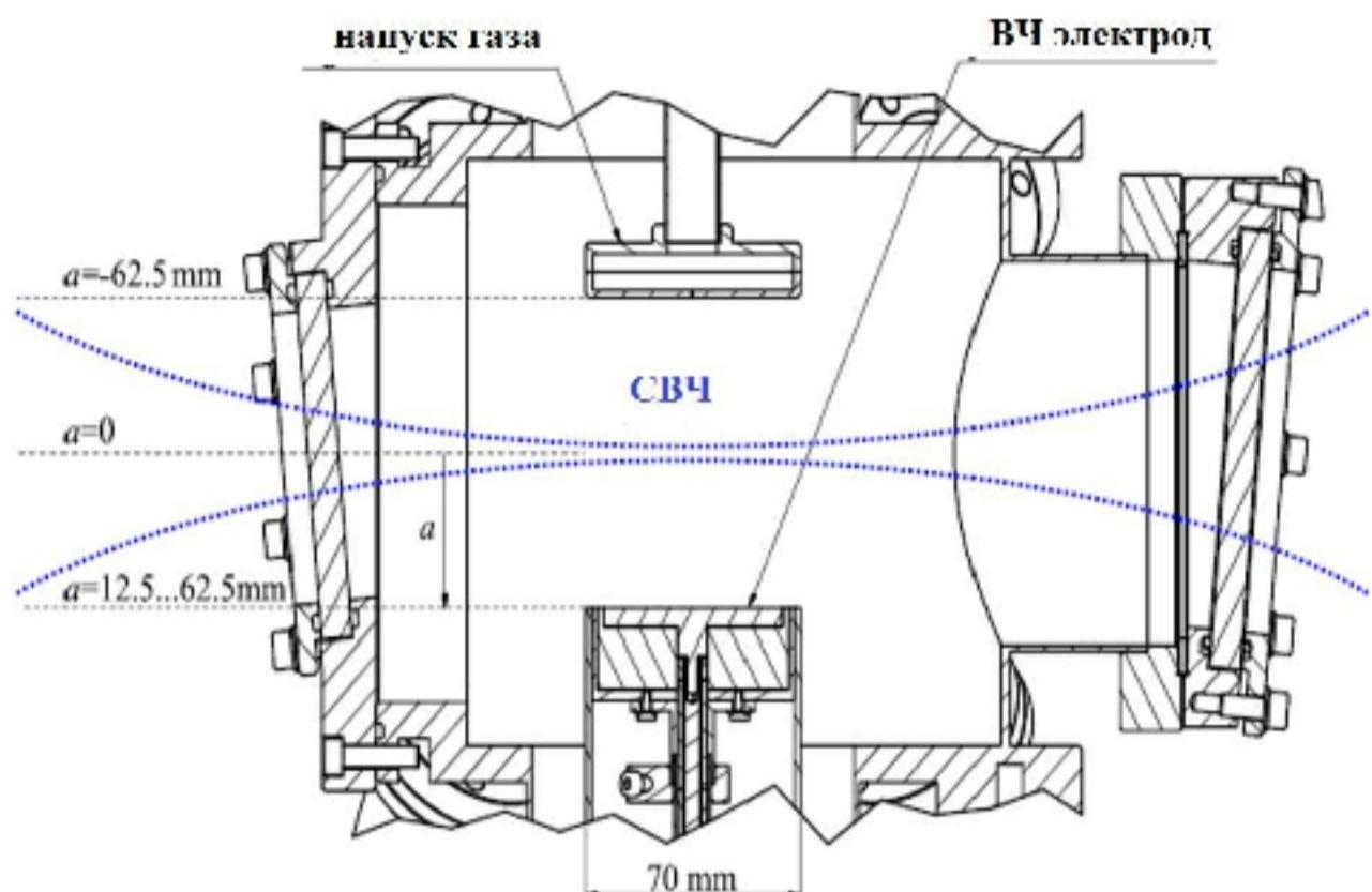
Рисунок 1.8 – Схема эксперимента для определения концентрации электронов в комплексной плазме с наночастицами методом микроволновой интерферометрии [52]
