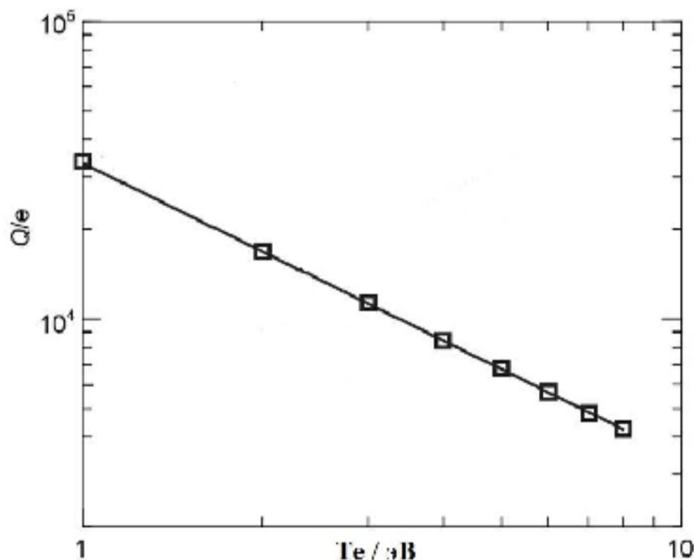
Рисунок 1.2 – Зависимость заряда пылевых частиц от температуры электронов фоновой плазмы определенная с помощью альтернативного метода
