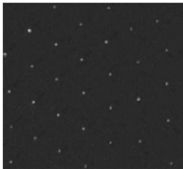
Рисунок 1.3 – Монослой пылевых частиц в приэлектродной области ВЧ разряда
