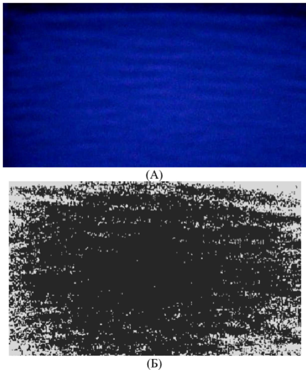
Реальное (А) и обработанное фото (Б), вид сверху, скорость камеры 25 к/сек, приложенное напряжение 15 кВ.
