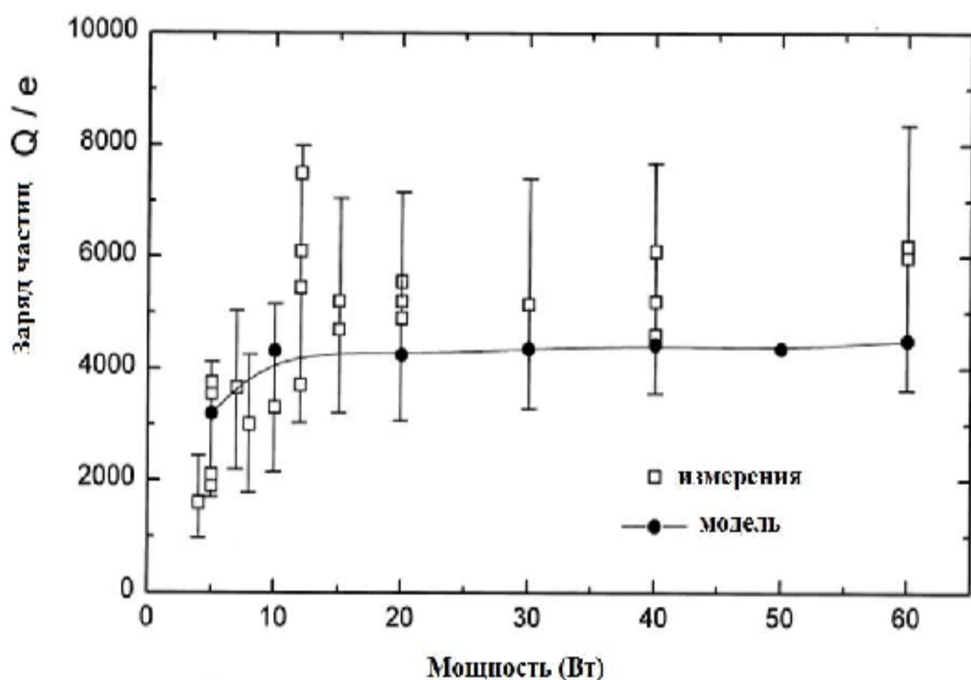
Рисунок 1.5 – Заряд пылевых частиц в зависимости от мощности разряда
