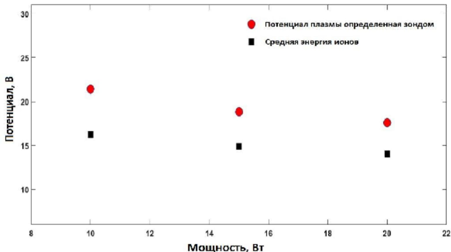
Рисунок 2.19 – Потенциалы плазмы, измеренные с помощью зонда и средние энергии ионов аргона определенные с помощью масс спектрометра в плазме чистого аргона при давлении 5,7 Па в зависимости от мощности разряда.
