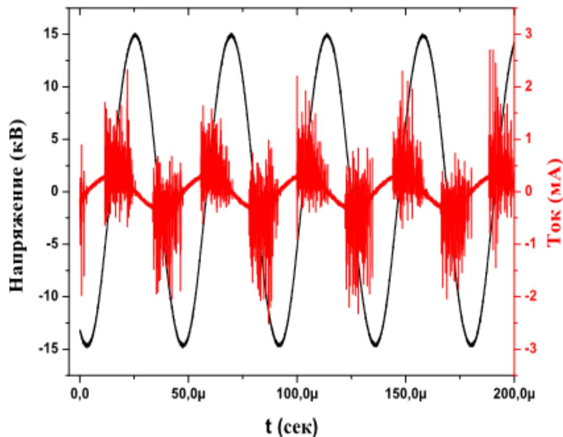
Рисунок 3.8 – Динамическая вольт-амперная характеристика диэлектрического барьерного разряда: геометрия электродов «плоскость-плоскость»
