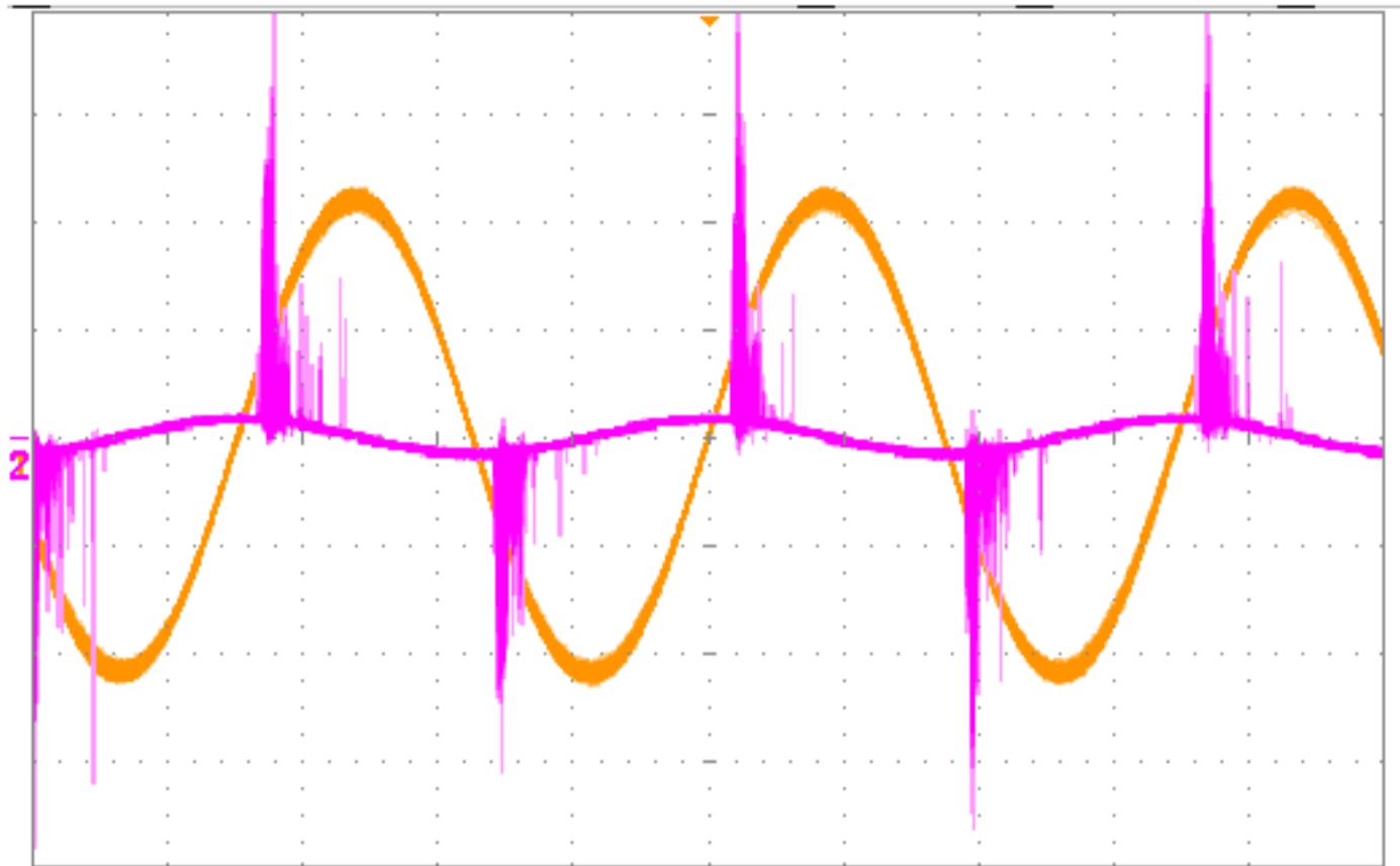
Рисунок 3.5 – Осциллограммы напряжения и тока полученные с помощью емкостного делителя
