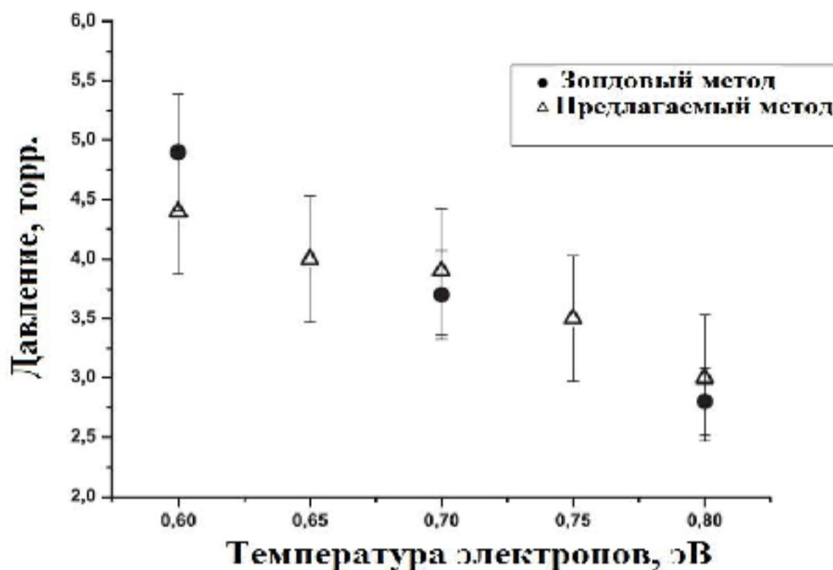
Рисунок 2.7 – Зависимость температуры электронов, определенная с помощью измерения радиуса области свободной от пылевых частиц вокруг электрического зонда от давления и ее сравнение с классическим зондовым методом.
